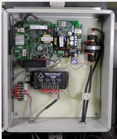
Armarios opcionales integradas con la estación base, Smart Nodo, interruptor y relé interruptor de mercurio (100A Hg)
