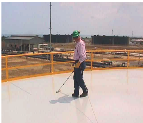
Prueba de discontinuidad de acuerdo a la norma ASTM 5162
