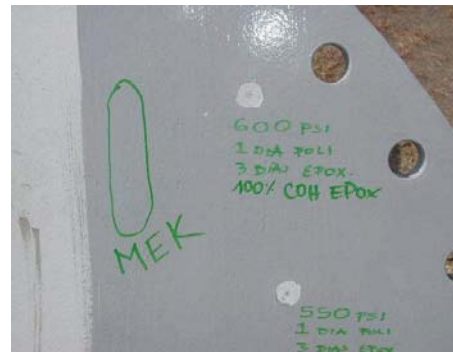
Prueba de Adherencia ASTM 4541.
